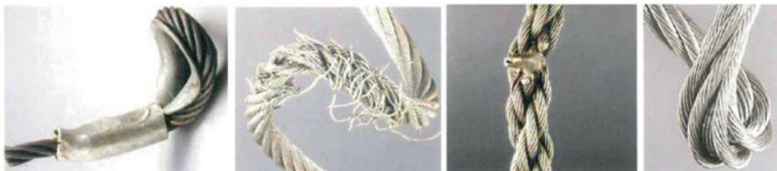
Figura 17. Eslingas de cables de acero o estrobos.
