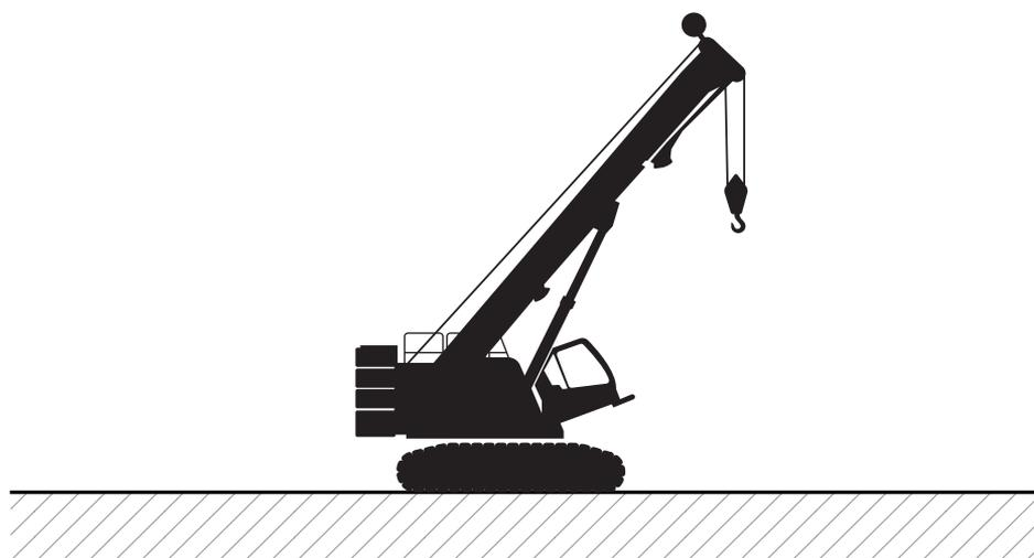
Figura 4. Grúa móvil telescópica sobre orugas.
